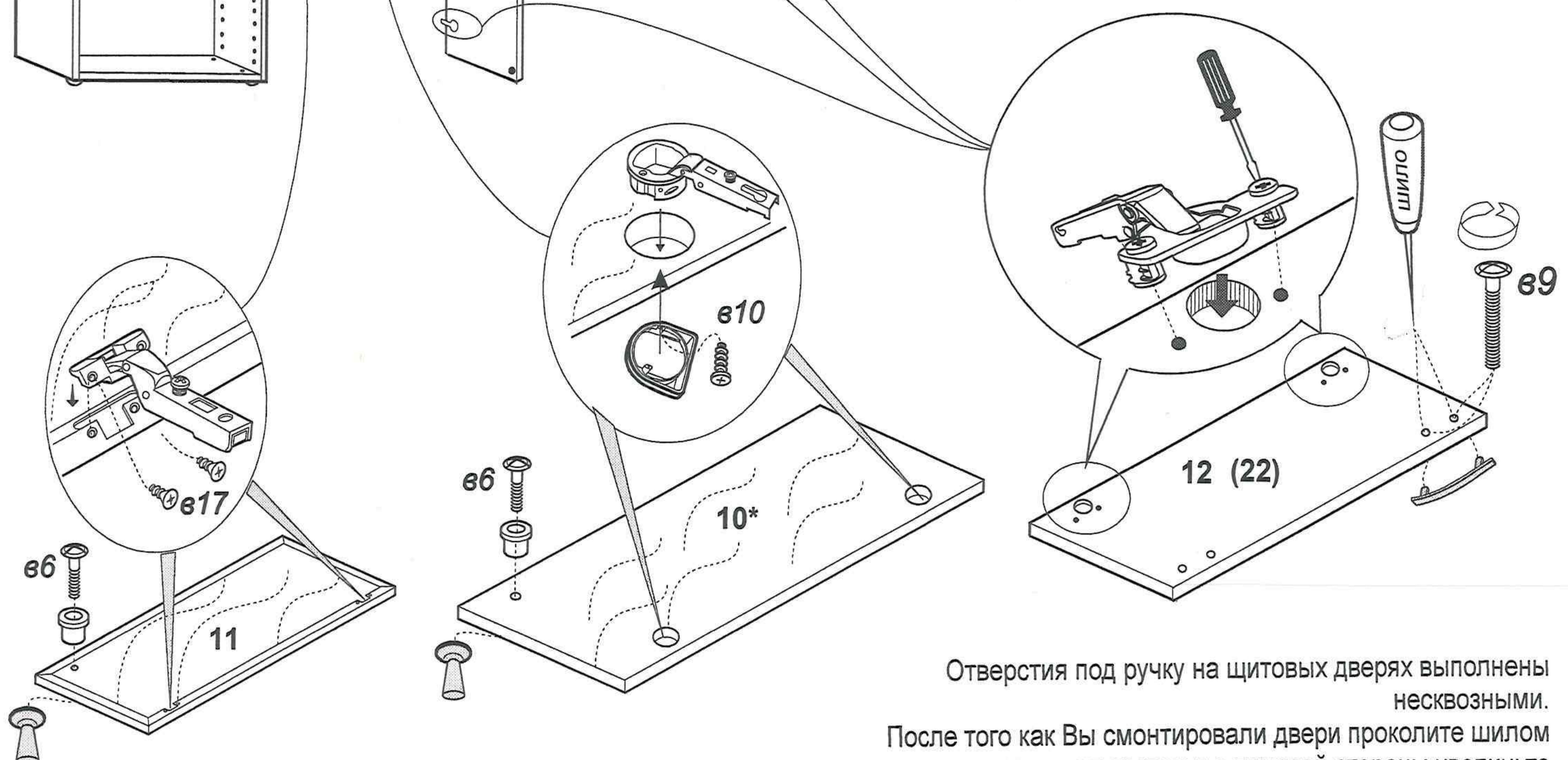
Отверстия под ручку на щитовых дверях выполнены несквозными.
